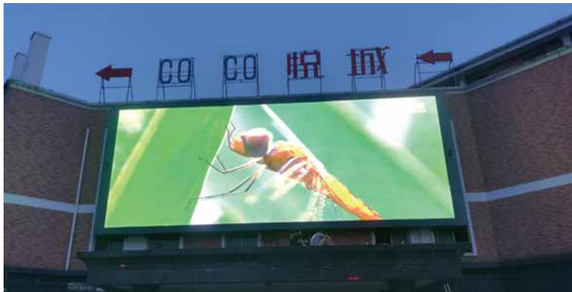
模组规格: P10 1504*608 48张接收卡, 1台VV-1视频处理器, 91平米
